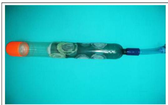
Sementara itu, bagian yang ke-tiga, yaitu pipa penghisap, fungsinya adalah untuk menjangkau larva/jentik yang berada di dalam tempat-tempat penampungan air (bak mandi, drum, dll). Gambar 3 menunjukkan pipa penghisap pada bagian alat secara utuh.
