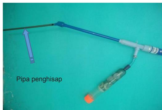
Cara menggunakan *Larvanto-mobile* diawali dengan menyatukan pipa penghisap dengan tabung penyaring, dan selanjutnya memasukkan pipa penghisap ke dalam air. Setelah pipa penghisap terendam air tekan tombol *on/off*. Lakukan penangkapan larva/jentik dengan mengarahkan ujung pipa penghisap pada jentik.
