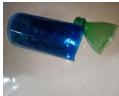
Gambar. 2 Potongan Botol Plastik Modifikasi Ovitrap
